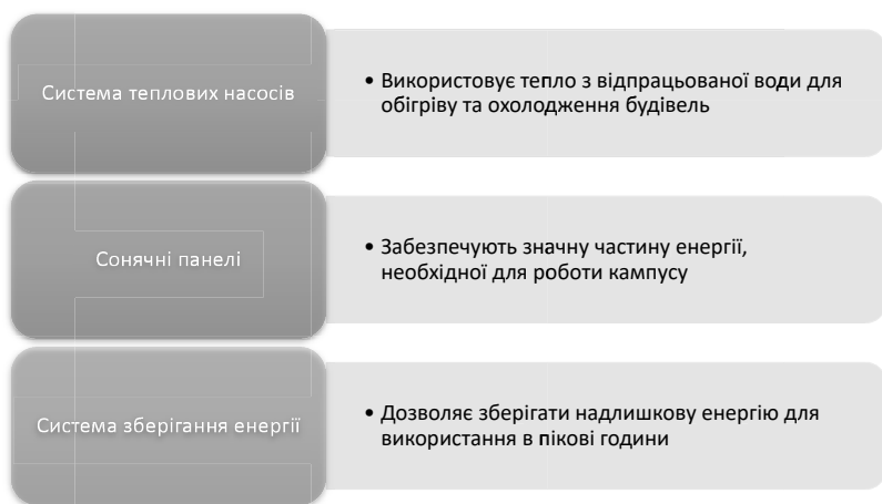
Рис. 1. Основні складові Стенфордського Центру Енергії (Stanford Energy System Innovations, SESI), побудовано автором за даними [8; 10]
